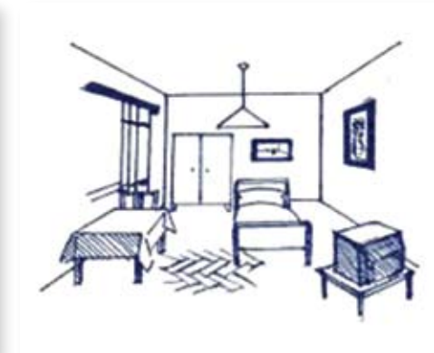
Soba za nepokretnog bolesnika u kojoj je omogućen pristup pacijentu sa sve četiri strane
